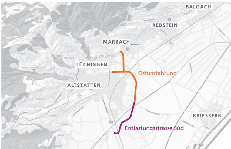
Altstätten liegt im Kreuzungspunkt zahlreicher Strassenverbindungen, die alle durch den historischen Stadtkern führen. Mittels einer Entlastungsstrasse Süd (bereits in Betrieb) und einer Ostumfahrung soll die Situation entschärft werden.
